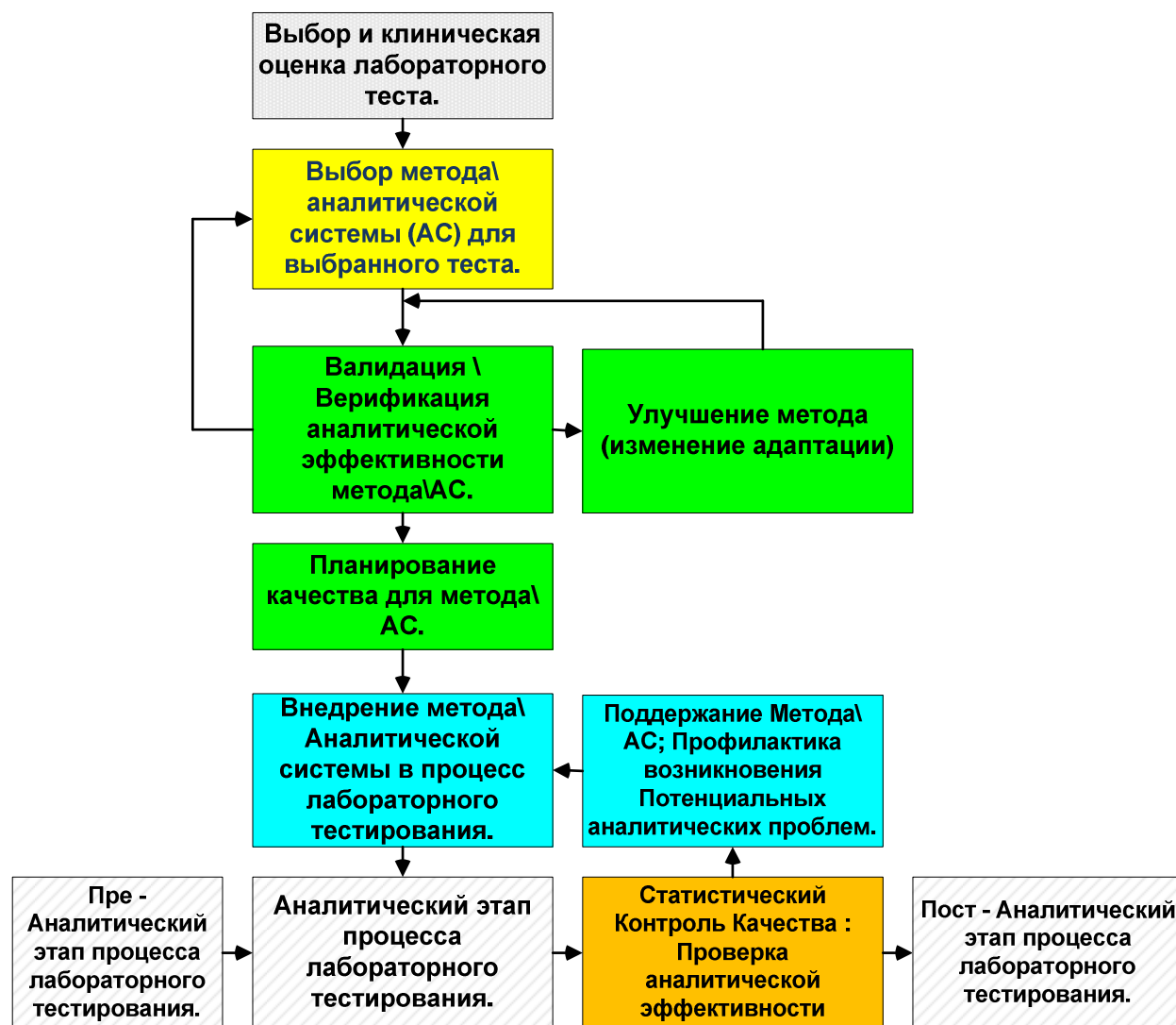
Рисунок 2. Локализация процесса выбора метода \ аналитической системы в процессе планирования аналитического качества. Зеленым цветом обозначены этапы процесса QP, цветом морской волны обозначены этапы качества лабораторных процессов (QLP), а кирпичным цветом обозначен процесс статистического контроля качества (QC).
