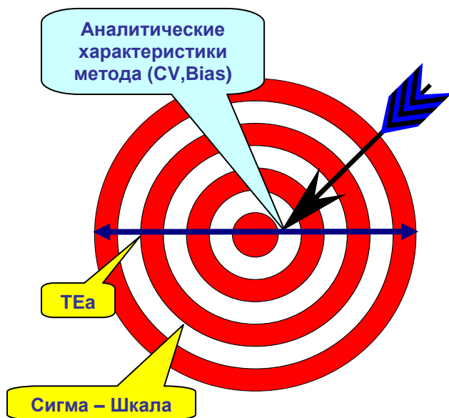
Рис 4. Модель мишени, демонстрирующая связь между сигма шкалой, спецификацией процесса (метода) тестирования (TEa) и аналитическими характеристиками (CV,bias) процесса (метода) тестирования.
